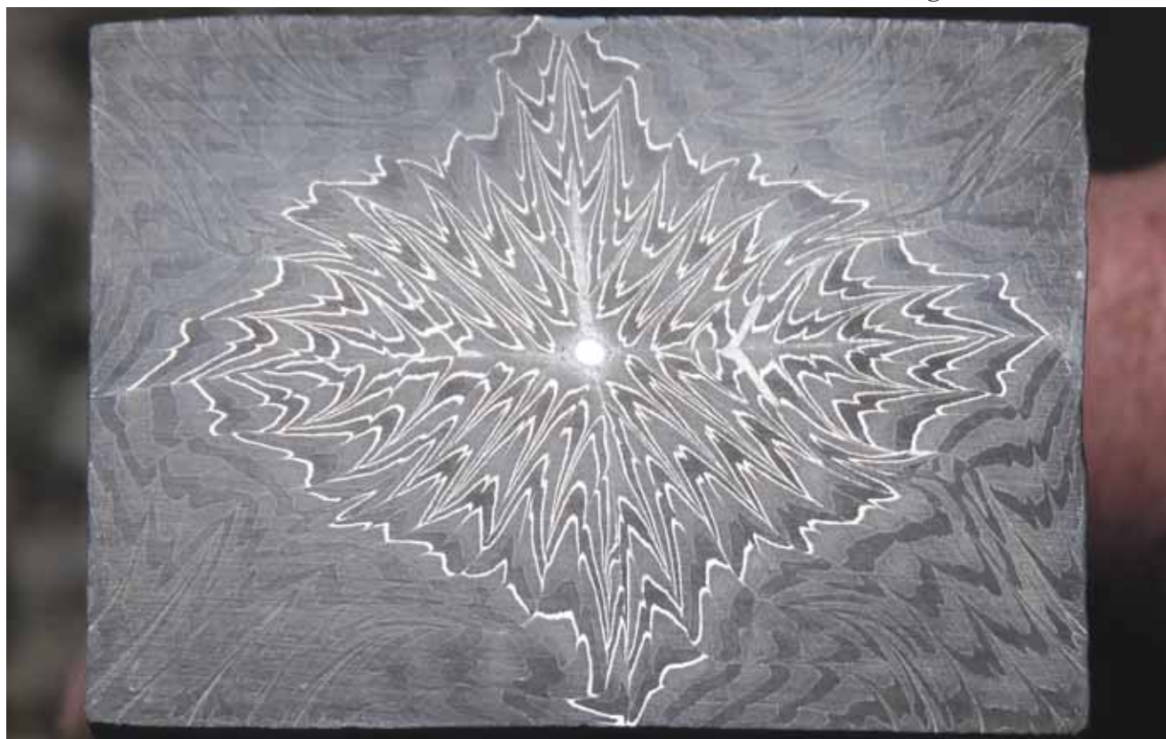
Ph. 3.67 La nuova barra ottenuta per assemblaggio: si notano le belle fiammature dell'esplosivo centrale con Nichel (L. Pizzi)
