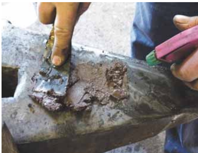
Ph. 2.42 Preparazione del secondo impasto Ph. 2.42 Preparing the secondary batch of paste
