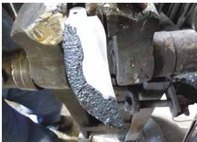
Ph. 2.41 Copertura del tagliente Ph. 2.41 Covering the cutting edge
