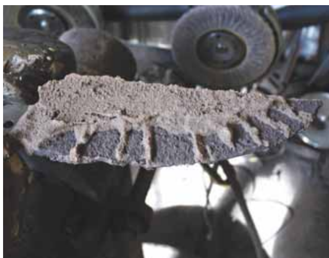
Ph. 2.43 Copertura della lama con il secondo impasto Ph. 2.43 Covering the blade with the secondary batch of paste
