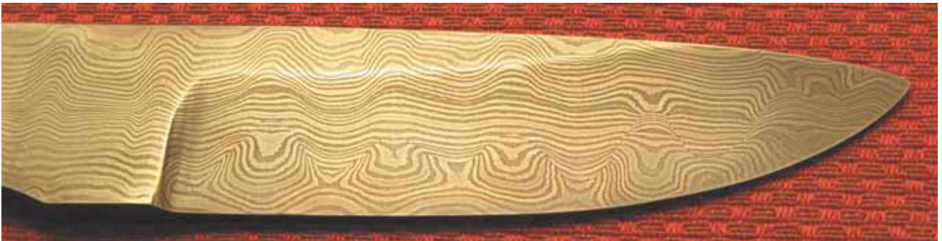
Ph. 3.56 Lama in damasco complesso fresato (F. Galizzi)
