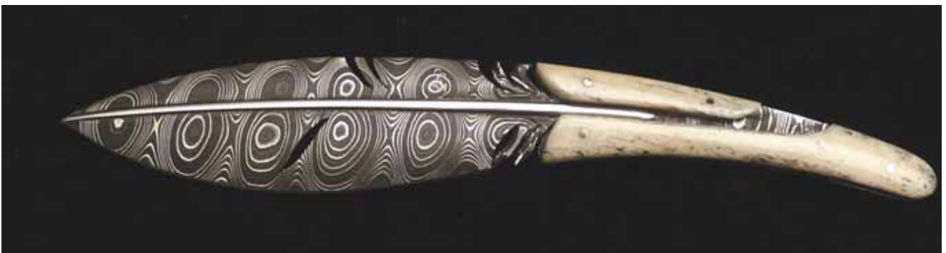
Ph. 3.57 Lama in damasco stratificato fresato forgiata da L. Pizzi e realizzata da G. Saviane
