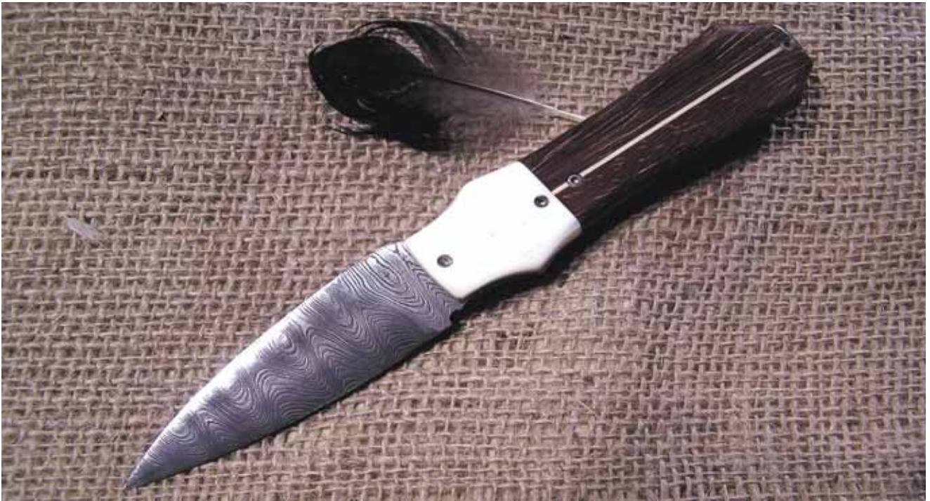
Ph. 3.55 Lama in damasco stratificato fresato (F. Galizzi)
