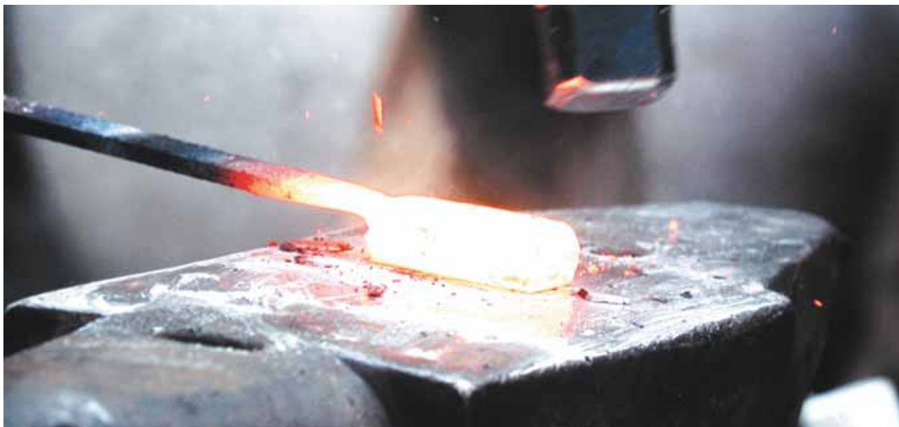
Ph. 2.14 Pacchetto al "bianco di saldatura" Ph. 2.14 Billet at welding temperature
